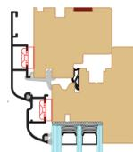
**SEZIONE** Sezione telaio legno 65x59 mm.
